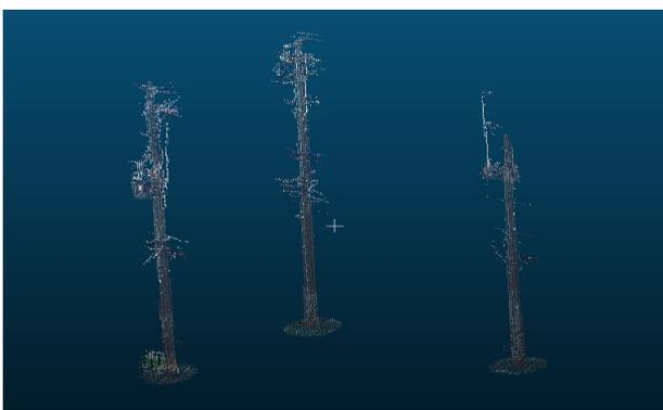
図 22 抽出した電柱の点群データ
