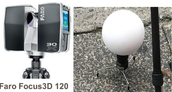
図 2 レーザー計測装置と識別用マーカ
