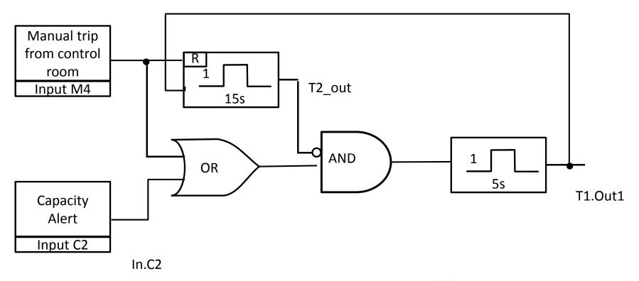
手動動作のときは強制排水開始の直後に15秒間全体的にセンサ入力の伝達を禁止、を意図している
