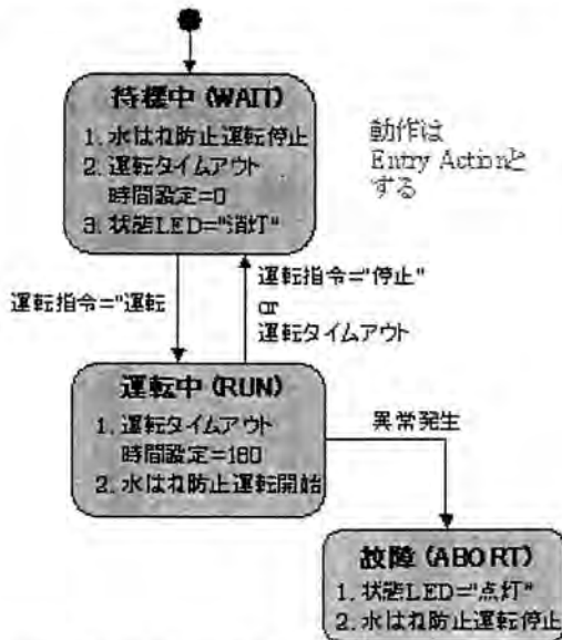
図9 運転管理プロセス状態遷移モデル 第1版
