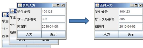
図7 シングルトンパターンの振る舞いの可視化
